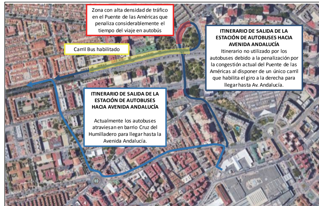
Ilustración 211: Propuesta de Ampliación de la Capacidad en el giro a derecha del Puente de las Américas sentido norte, incluyendo ligera ampliación de la capacidad de dicho tramo del Puente.
