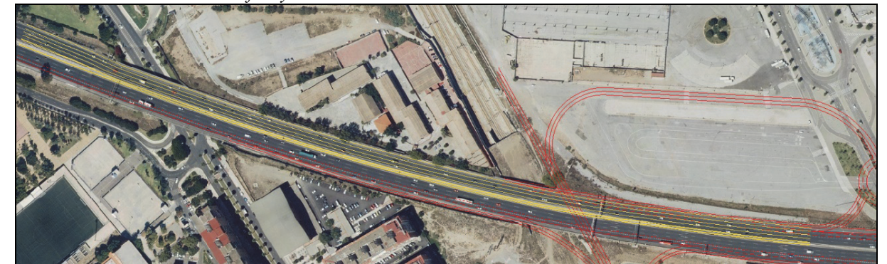
Ilustración 147: Posibilidad de ampliar sección en MA-20 para general nueva vía colectora-distribuidora entre acceso MA-20 Camino San Rafael y P.I. Sta. Bárbara.
