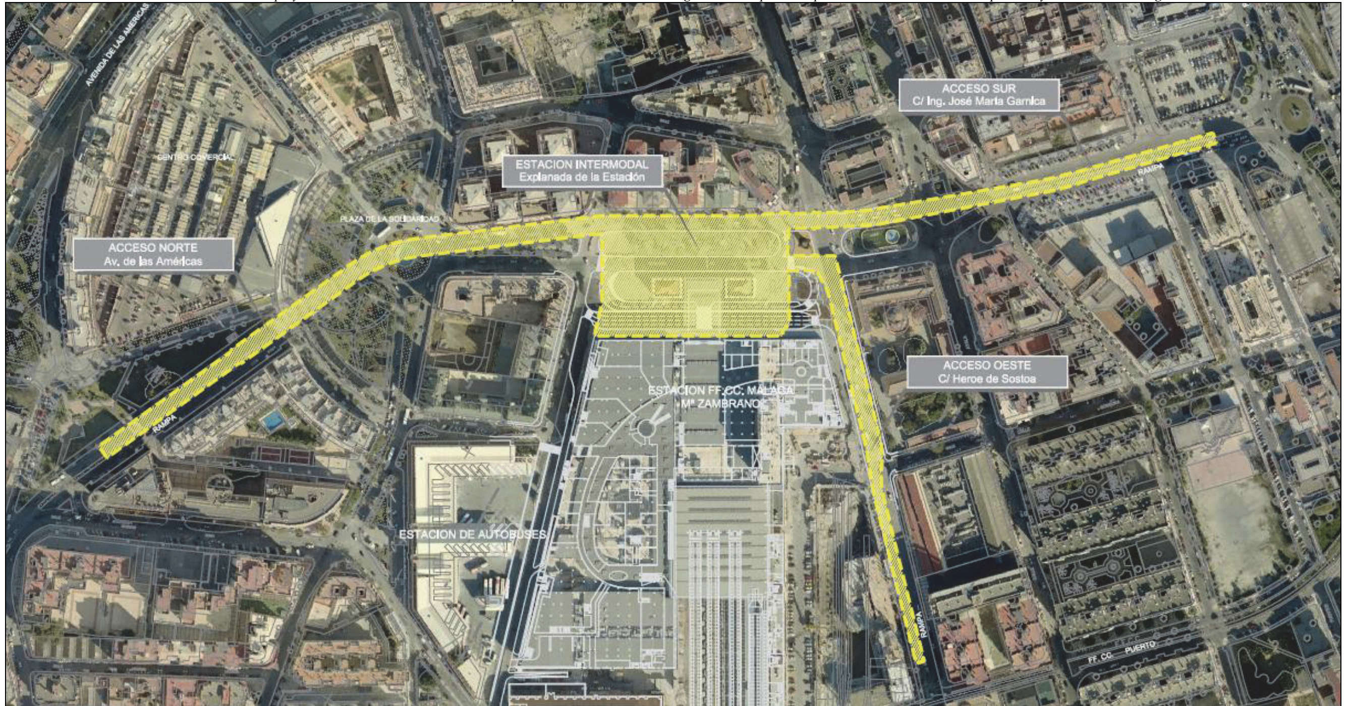
Ilustración 153: Accesos Motorizados en el "Anteproyecto de Intercambiador Modal de la Explanada de la Estación de Málaga" realizado por la Empresa Estudio Pereda 4 en 2009 para el Ayuntamiento de Málaga.
