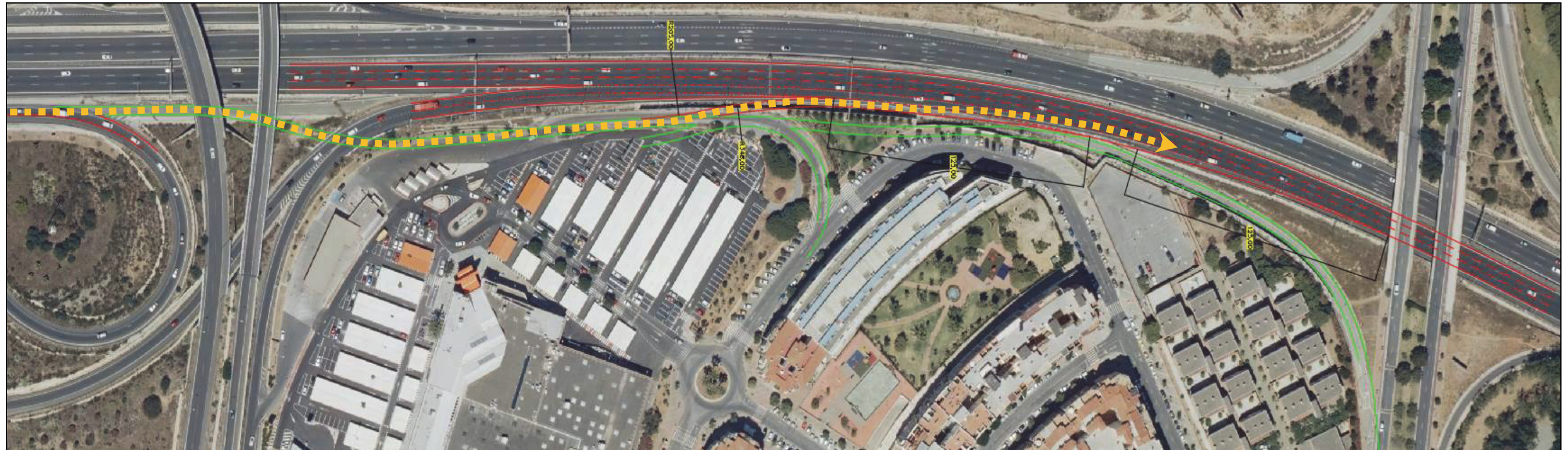
Ilustración 138: Propuesta general del nuevo vial de GMU y conexión con la MA-20 para salida hacia el norte.
