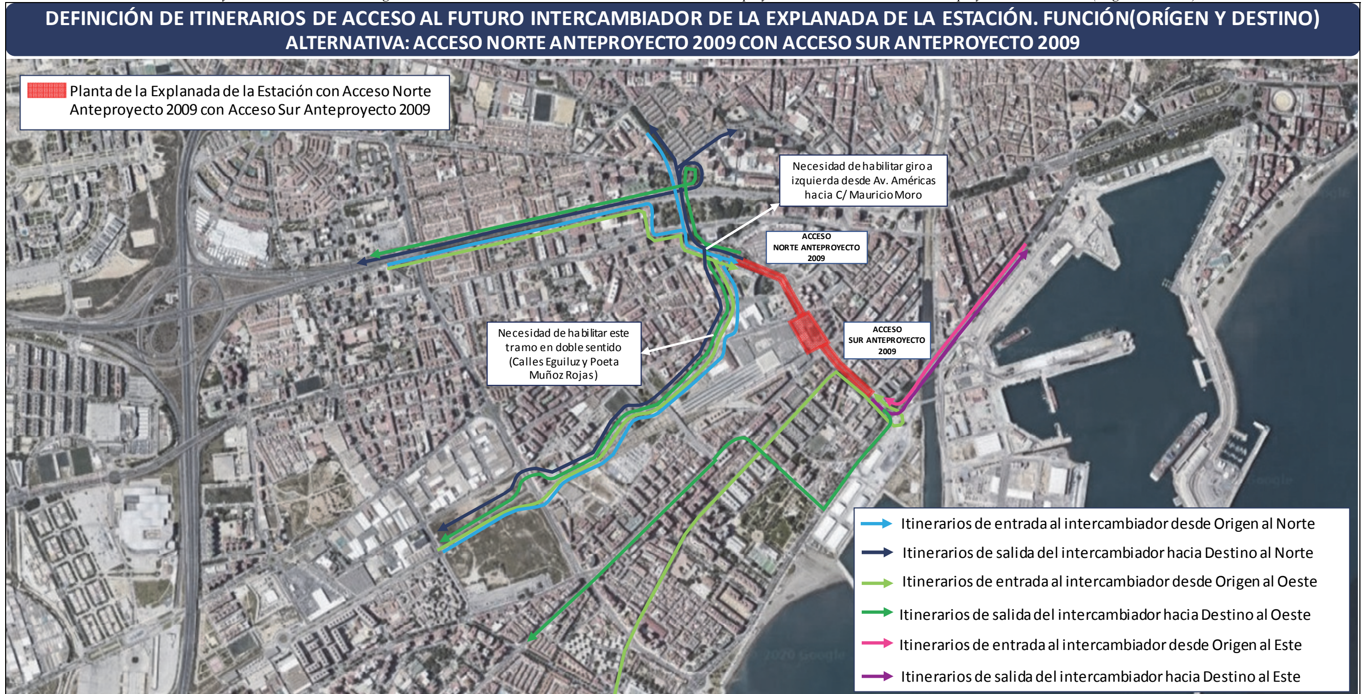
Ilustración 182: Itinerarios de entrada y salida al intercambiador según el acceso utilizado en la Alternativa 1: Acceso Norte del Anteproyecto 2009 con Acceso Sur del Anteproyecto 2009. Función (orígenes-destinos).
