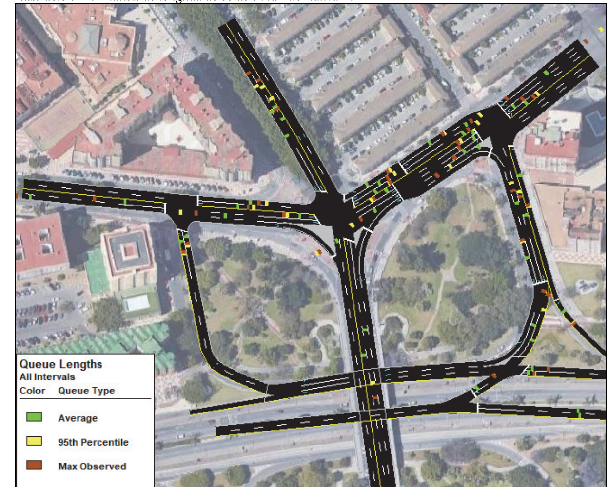
Ilustración 22: Análisis de longitud de colas en la Alternativa A.
