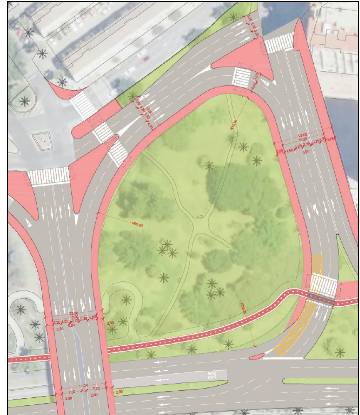
Ilustración 7: Alternativa B: Proyección en el Puente de las Américas de 3 carriles en sentido norte desde el estribo norte del mismo.
