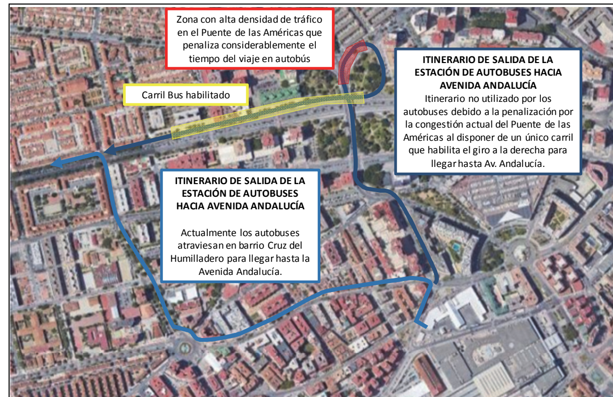
Ilustración 106: Propuesta de Ampliación de la Capacidad en el giro a derecha del Puente de las Américas sentido norte, incluyendo ligera ampliación de la capacidad de dicho tramo del Puente.
