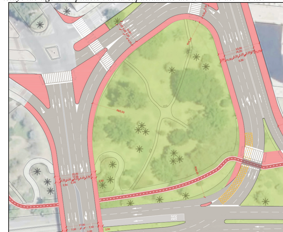
Ilustración 106: Propuesta de Ampliación de la Capacidad en el giro a derecha del Puente de las Américas sentido norte, incluyendo ligera ampliación de la capacidad de dicho tramo del Puente.
