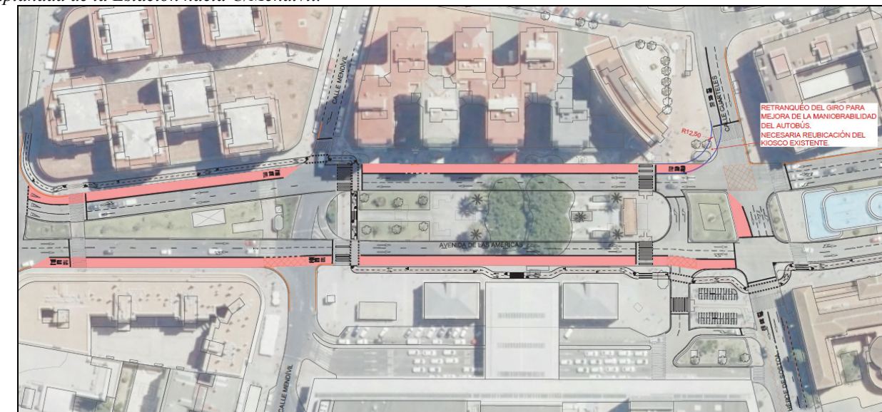
Ilustración 210: Propuesta de Carril Bus en la Explanada de la Estación y eliminación de giro a izquierda desde Explanada de la Estación hacia C/Mendivil.
