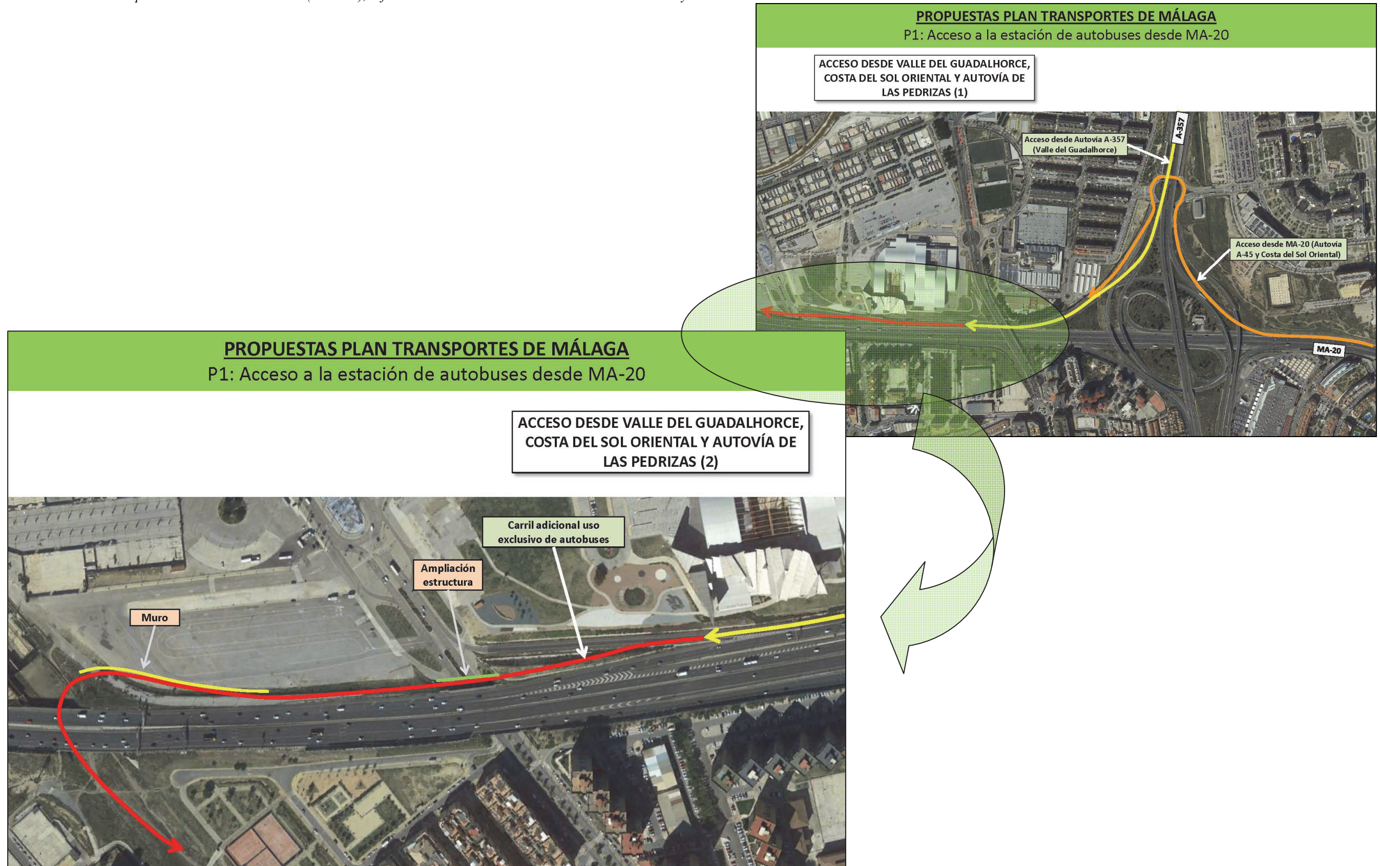
Ilustración 116: Propuesta incluida en el PTM AM (CTMAM), referente a la salida desde el norte de la Autovía MA-20 y entrada al vial sobre el soterramiento del Ferrocarril.
