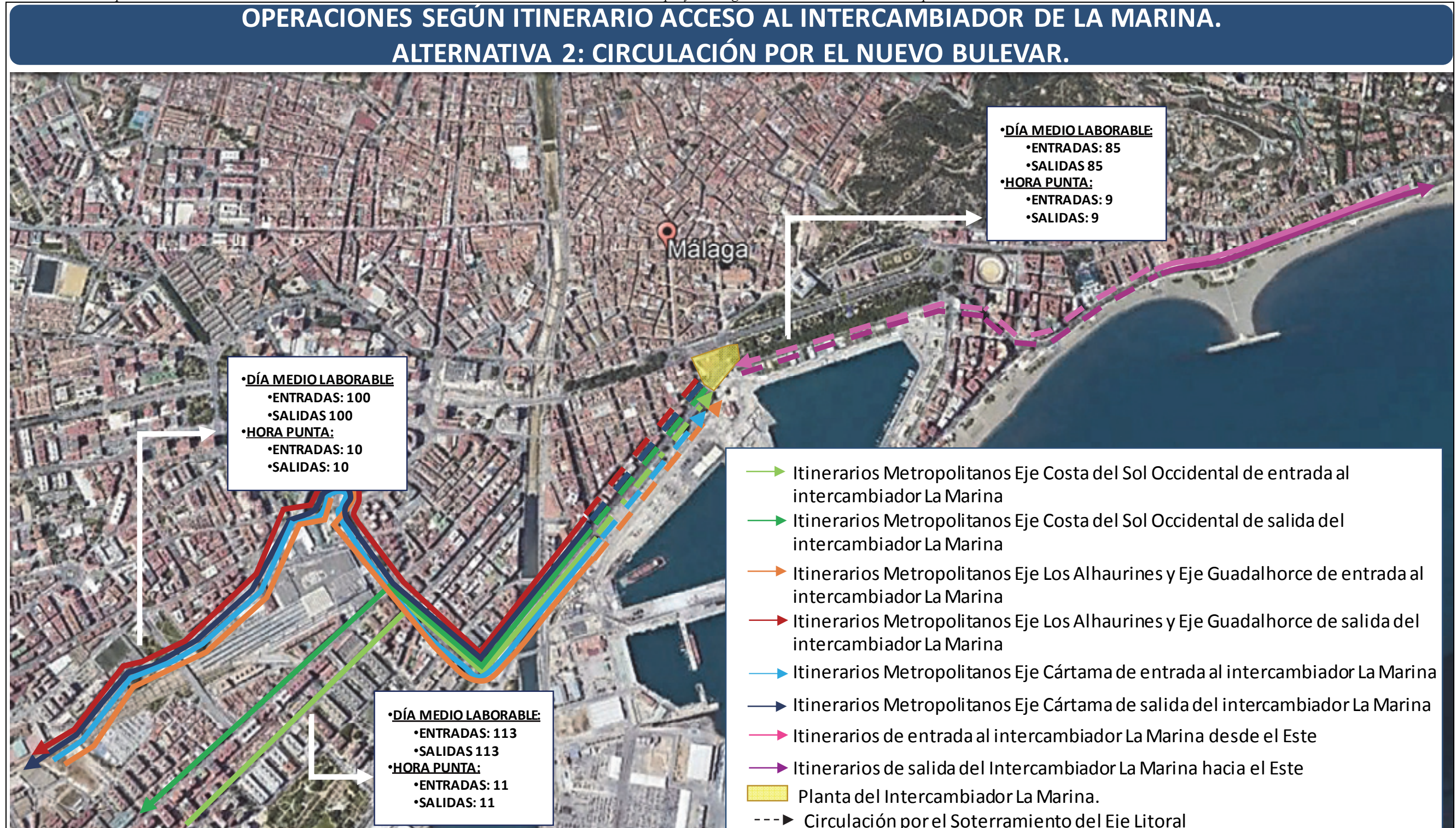
Ilustración 205: Operaciones medias de un día laborable en el intercambiador de La Marina en el horizonte de proyecto según la Alternativa 2, circulando por el nuevo Bulevar.
