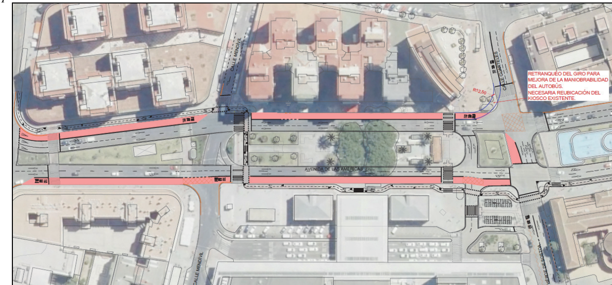
Ilustración 105: Propuesta de Carril Bus en la Explanada de la Estación y eliminación de giro a izquierda desde Explanada de la Estación hacia C/Mendivil.
