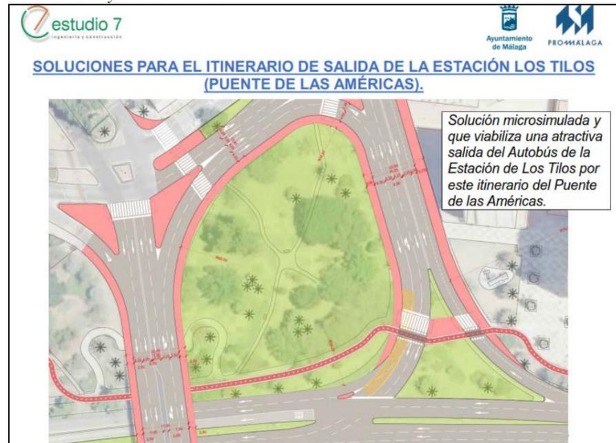
**Ilustración 56:** Microsimulación realizada en el Puente de Las Américas, incluido en la Propuesta de Accesibilidad a la Estación de Los Tilos y de Itinerarios de Acceso a las Futuras Estaciones de Intercambio Modal de la Explanada de la Estación y de La Marina.
